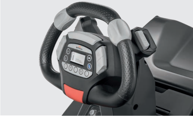
Opsiyonel STILL Easy Move kumanda değiştiriciler ile eş zamanlı sürüş ve kaldırma imkanı
