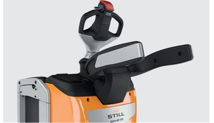
Opsiyonel katlanır yan korkuluklar sayesinde platformda emniyetli ve ergonomik konum alma imkanı
