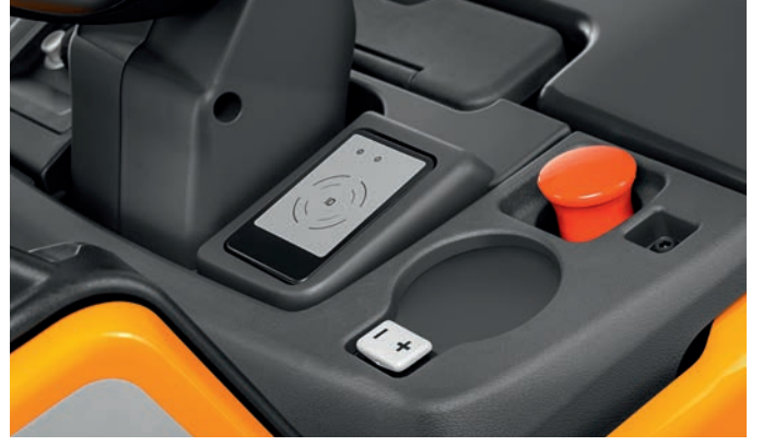
Çeşitli erişim seçenekleri ve basmalı düğme ile ayarlanabilen (+/-) ayakta durma platformu
