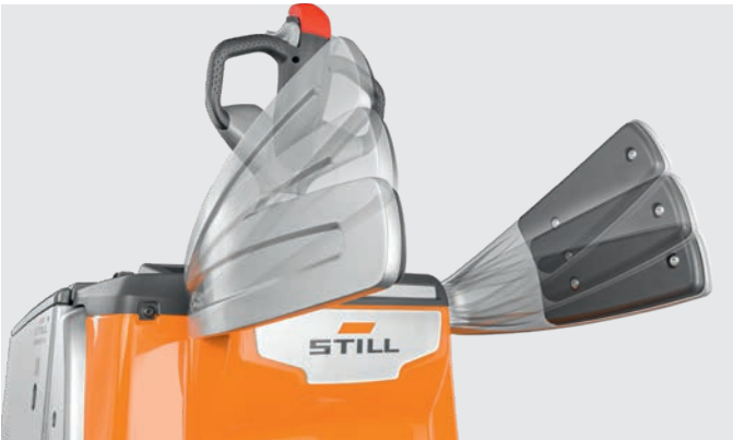
Yüksekliği ayarlanabilir yan korkuluklar sayesinde boyu ne olursa olsun tüm operatörler her iki yandan güvenli şekilde desteklenir
