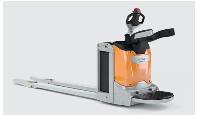
Yatay ürünlerin taşınmasında verimliliği artırmak için, EXH-SF 16C/20C opsiyonel olarak 2400 mm çatallarla da temin edilebilir
