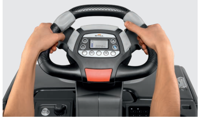
Yüksekliği ayarlanabilir STILL Easy Drive direksiyon sayesinde tüm fonksiyonlar tutuş değiştirmeye gerek olmaksızın sağ ve sol elini kullanan operatörler tarafından ergonomik kontrollerle kullanılabilir
