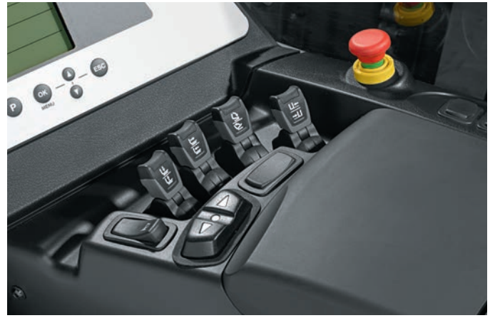
Parmak ucu ile çalıştırma sayesinde kavrama yerini değiştirmek zorunda kalmadan tüm fonksiyonları kolayca çalıştırma
