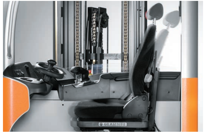
Özgün, rahat, arkaya yatırılabilir koltuk sayesinde malların üst ve arka tarafını rahat görüş
