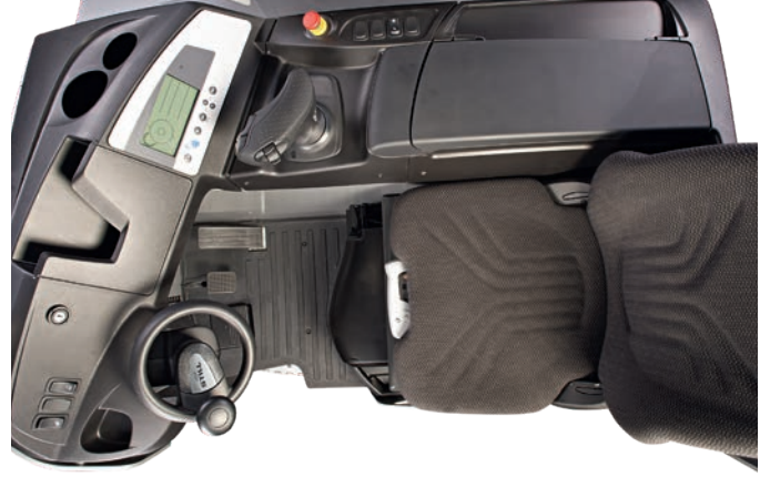
Bağımsız olarak ayarlanabilir sürücü çalışma alanı
