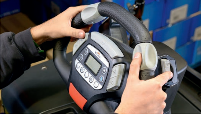
En iyi sürüş deneyimi ve tutuşu değiştirmeden tüm fonksiyonların kontrolü için benzersiz STILL Easy Drive direksiyon simidi
