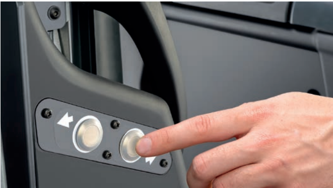
Yüksek toplama yoğunluklarında bile geliştirilmiş elleçleme/taşıma için çift taraflı yaya modu
