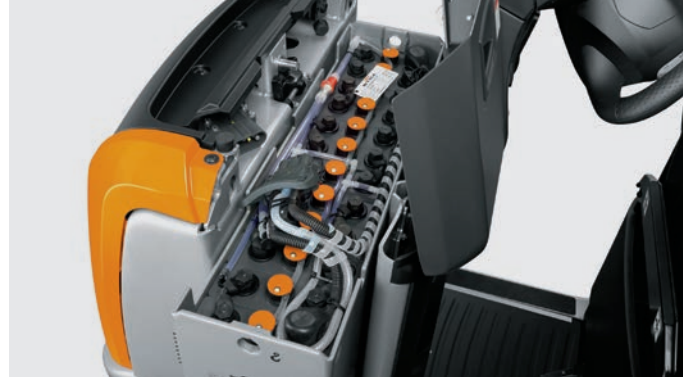
İsteğe bağlı yanal akü değişimi, maksimum kullanılabilirliği ve en iyi sürücü ergonomisini garanti eder
